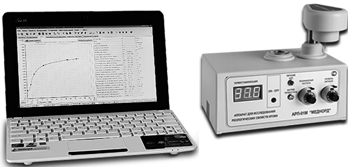
Рис. 3. Аппаратно-программный комплекс АРП-01М, «Меднорд» с программой «ИКС ГЕМО-3»
